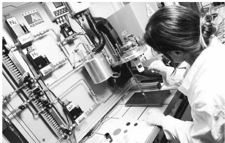
Banc de test (SOFC) de cellules de piles à combustible tout solide
